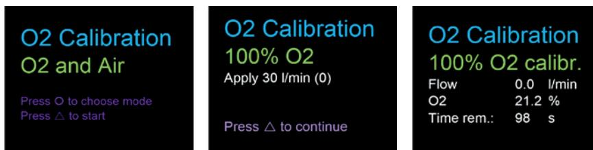
Figura 26: Indicaciones en pantalla «Calibración oxígeno y aire»
