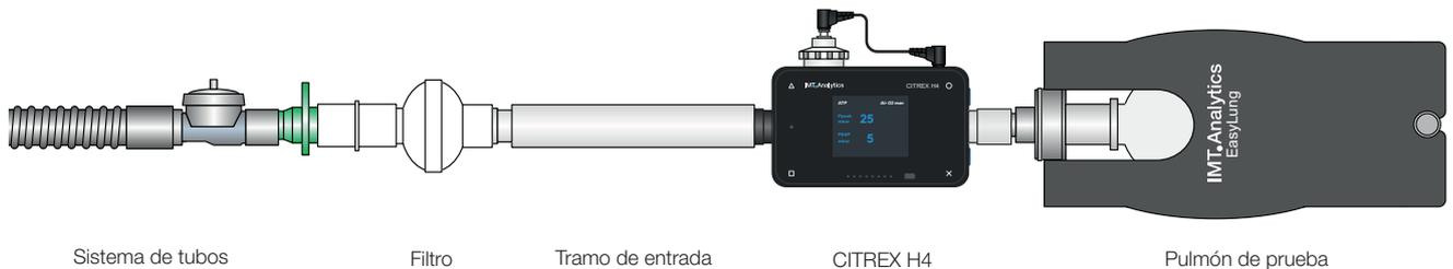
Figura 29: Configuración de medición para la comprobación de respiradores
