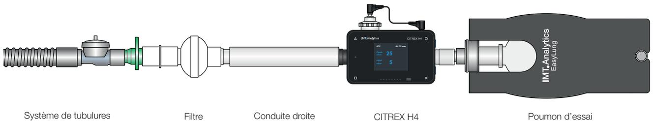
Figure 29 : Structure de mesure de vérification de dispositifs de ventilation
