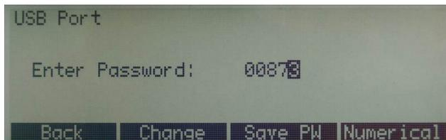
Para introducirlo, pulse **Activar**. Aparecerán diferentes cifras seleccionables con las teclas de flecha. **Cambiar** le permite asignar a cada una el valor deseado y aceptarlo con **Guardar**.
