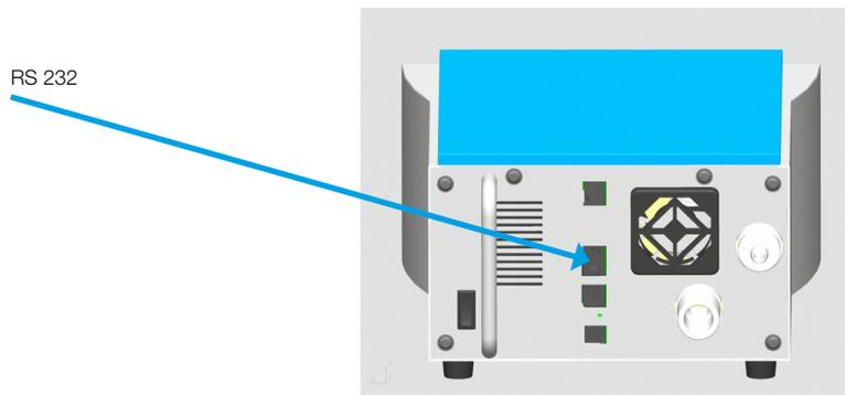
El puerto RS 232 se controla a través de un cable RS 232 especial. Si desea controlar el aparato a través de la interfaz RS 232, su distribuidor estará encantado de proporcionarle un protocolo detallado.
