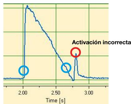
Esta curva muestra la curva del flujo en el canal de inspiración delante de la pieza en Y. Los dos primeros círculos marcan los activadores que se deberían utilizar en este caso.
