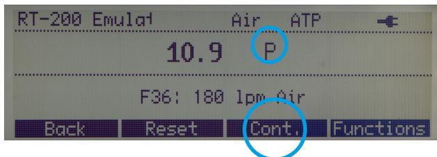
Este modo de medición permite visualizar inmediatamente los valores de pico. Para pasar al modo de medición continuo, pulse **Cont.**
