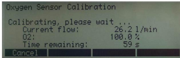
Tras iniciar la calibración, se debe aplicar primero oxígeno al 100 %, de acuerdo con la indicación del aparato, y después aire ambiental. En ambos pasos es importante que haya suficiente cantidad del gas correspondiente fluyendo por el canal de medición principal, durante el tiempo preciso. La calibración de cada gas requiere unos 75 segundos. El caudal óptimo es de 20 a 30 l/min y no debe modificarse durante la calibración.
