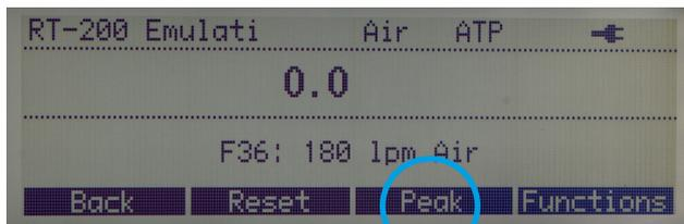
Este modo de medición le permite visualizar mediciones actuales. Para pasar al modo de medición "Peak", pulse **Peak**.
