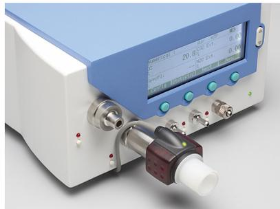
El sensor se debe instalar entre la fuente de gas y FlowAnalyser.
