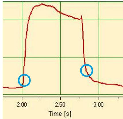
En este caso se pueden volver a utilizar los activadores predeterminados para la curva de presión: ( $> 1$  mbar /  $< 1$  mbar).
