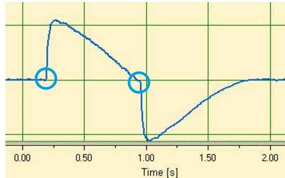
En este ejemplo se muestra una curva de flujo detrás de la pieza en Y. Los activadores predeterminados ( $> 3$  l/min /  $< -3$  l/min) se pueden utilizar en este caso sin problemas.
