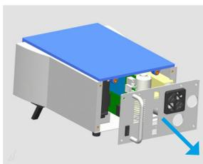
Tire con cuidado hacia atrás de la placa posterior. No dañe las conexiones de los cables.
