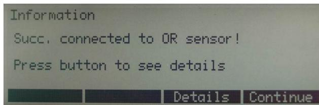
Esta información en pantalla indica que la conexión entre FlowAnalyser y el sensor OR se ha establecido correctamente.
