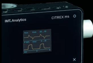
CITREX H4 ist für eine mobile und mühelose Anwendung ausgelegt und entspricht allen Anforderungen für den täglichen Einsatz im Feld. Seine zahlreichen Funktionen ermöglichen eine fortgeschrittene Leistungsprüfung verschiedener medizinischer Geräte. Das CITREX H4 eignet sich, um Beatmungs- und Anästhesiegeräte, Sauerstoffmischer oder Absaugeinrichtungen zu überprüfen.
